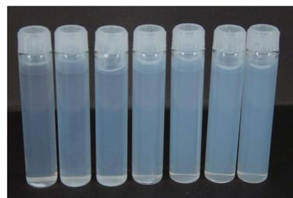
図2.液面プラズマ処理後の  $\text{TiO}_2$  の分散状態
